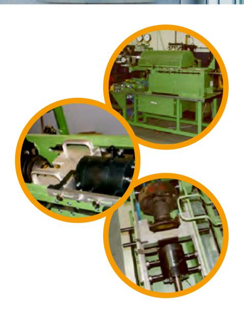
Montage und Entwicklung eines Bremszylinderprüfstandes zur Montage, Demontage und Prüfung von Bremszylindern KNORR und SAB WABCO
